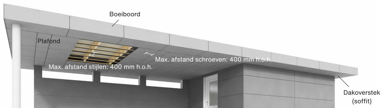
Tussenafstanden van schroeven en regelwerk
