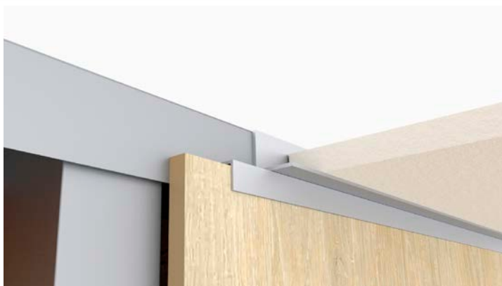
Plafondafwerking m.b.v. twee aluminium L-profielen.
