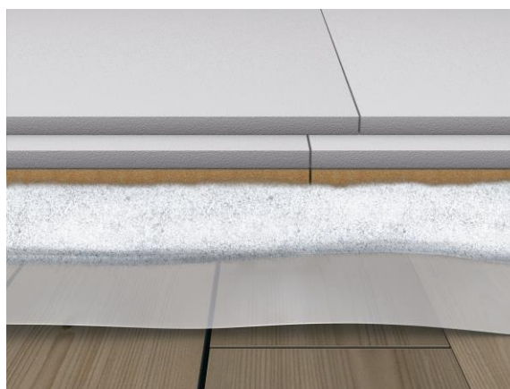
Onder vloer houten delen met toepassing van egalisatiekorrels met FERMACELL Beschermingsfolie
