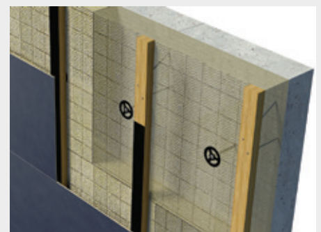
Thermisch geoptimaliseerde bevestigingswijze met afstandschroeven
