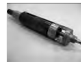
11. Boor met centreerhuls 11 mm voor UNI-rivet. Boordiameter 4,1 mm
