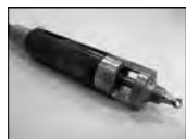
10. Boor met centreerhuls 11 mm voor UNI-rivet. Boordiameter 4,1 mm
