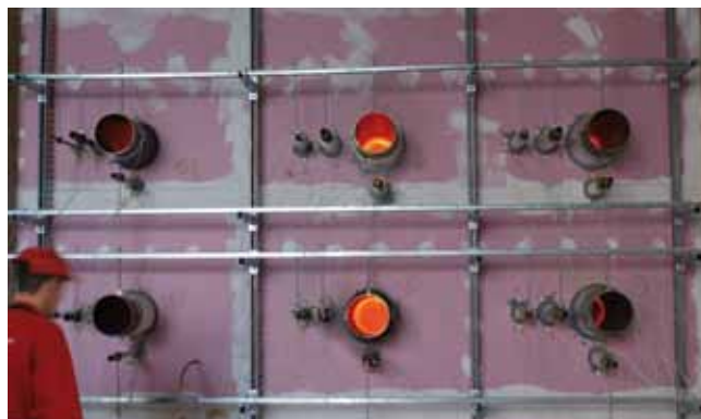
Metalen leidingen met en zonder isolatie tijdens de test.
