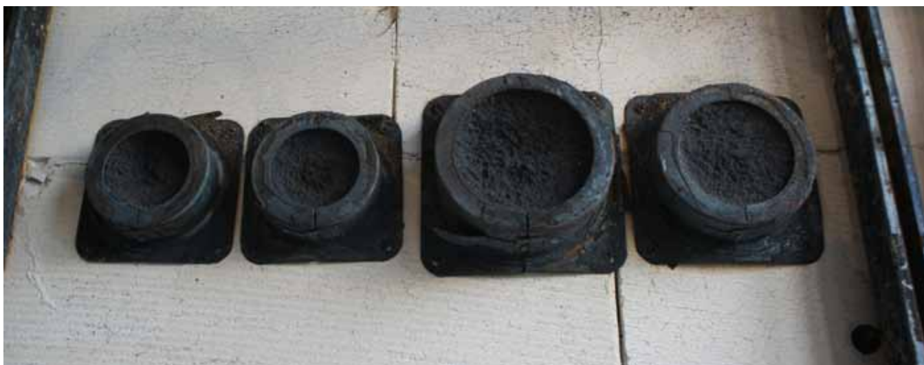
Opgeschuimde brandmanchetten ná de brandtest.
